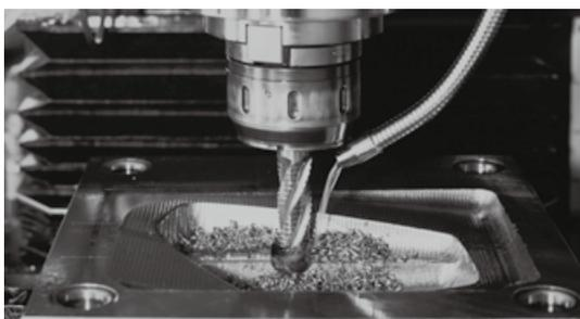
図 5.5.2 ラフィングエンドミルの切りくず
