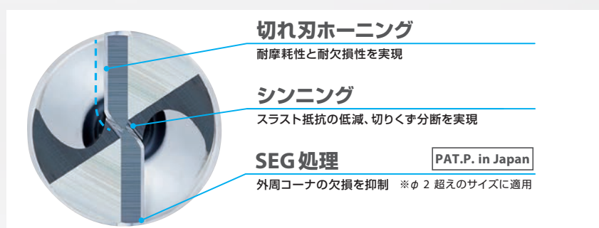
図 1 AD-MICRO 刃形写真と形状説明図
