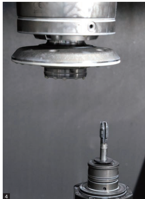
1 & 2. C56 製のホイールハブ。この部品には、 M14×1.5 ねじ立て長さ 16mm（通り）の加工が 5 箇所あります。 3. Bifrangi 社オーストリア工場で稼働する EMAG GmbH & Co. KG 社製の立形 CNC 旋盤 VL 4。 4. オーエスジー製 VI-HS-POT で加工中の C56 製ホ イールハブ。
