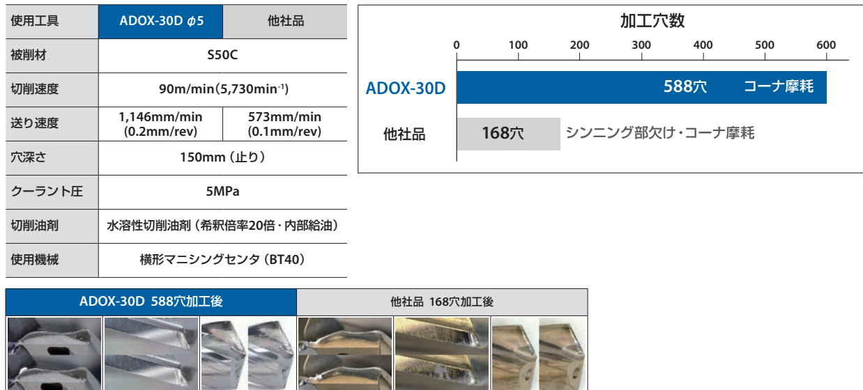
図4 30Dの深穴加工も高能率で長寿命
