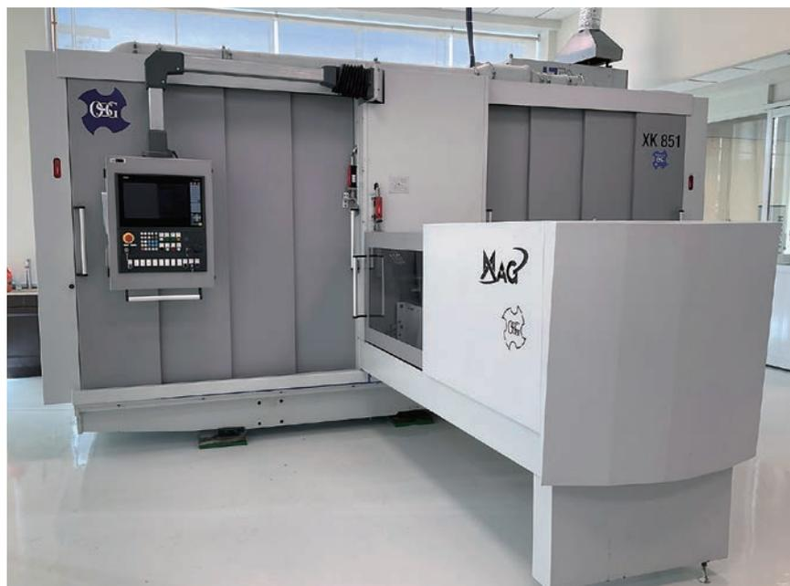
OSG EX-CELL-O XK 851-6Eは、ドライブシャフト、アクスルシャフト、電気モータ部品などの自動車部品の高効率な転造加工を可能にするために開発された先進的なCNC転造盤です。
