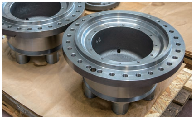
ダクタイル鑄鉄 GS-600(FCD600) 製のギヤボックスの部品。各部品には、ねじサイズ M24×3、精度等級 6HX、ねじ立て長さ 40 mm (通り) のねじ加工が 30 か所あります。
