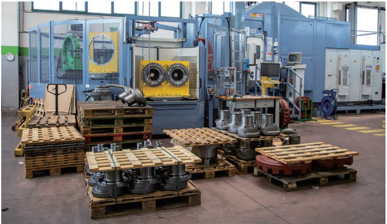
ギヤモーター用の遊星軸受ハブの加工に使用される MPC 社の MCM Tank シリーズ 横形マシニングセンタ（HSK-A100）
