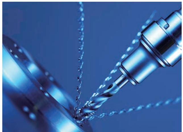
オーエスジーのAタップは、工具の管理を単純化するために開発された多機能なタップ製品群で、多様な被削材と用途においてその卓越性を発揮します。止まり穴のスパイラルタップでトラブルのない切りくず排出を実現することは特に難しく、多くの作業者たちを悩ませてきました。この問題を解消し、切りくずをより良好に排出できるように、オーエスジーのA-TAP A-SFTには不等リード溝が採用されており、これにより安定的な切りくず排出を可能にし、切削抵抗を削減することに成功しています。ねじれ角は、切りくずが形成される食付き部から、排出される溝へと移動します。この独自の形状により、切りくず管理をより良好に行うことが
