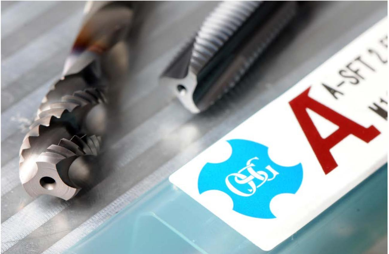
て提供している油穴を A-SFT の溝部に付けることを推奨しました。特別な潤滑油の効果で、切りくずはねじ加工が行われている間にスムーズに排出されるようになりました。さらに、以前使用していた工具では、安定した切りくず形状にするために、切削速度 35mm/min を維持する必要がありました。切削速度が 35mm/min を超えると、切りくずの量が増え、排出させることがより困難となりました。しかし、A-SFT を採用することで、切削速度を 35mm/min から 50mm/min に引き上げ、加工効率が 42.8% も上昇しました。
