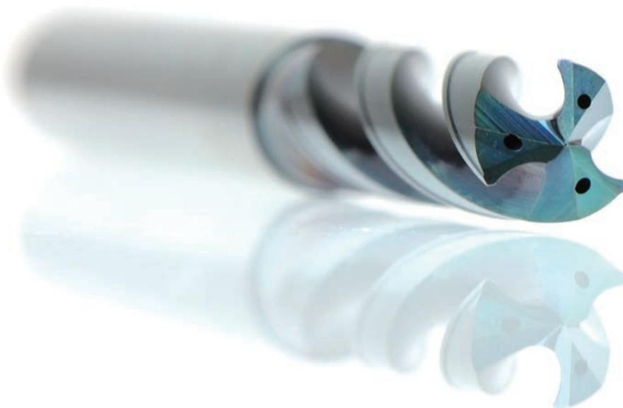
TRS 「Mega Muscle」ドリルは、2 枚刃ドリルよりも 1.5 倍から 2.0 倍の送り速度で加工できるように設計されています。TRS は、現在、鋳造アルミニウム、鋳鉄、炭素鋼、合金鋼、金型鋼、ステンレス鋼、45 HRC 未満の焼入れ鋼において、油穴付きドリルを使用しているアプリケーションに適しています。
