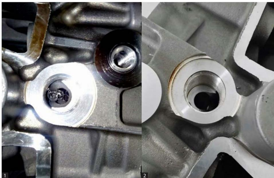
1. 切りくずの排出は、アルミニウム製エンジンシリンダブロックの生産で顧客を悩ませていた問題でした。切りくずを毎回手作業で除去しなければならず、製造作業の安定性と効率化に影響が及んでいました。
