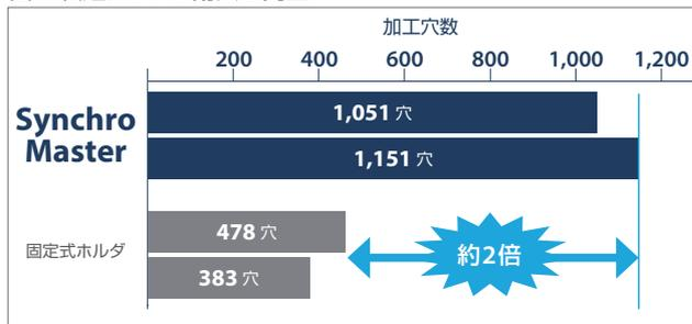
被削材：SCM440 (30HRC) 使用工具：S-XPf M10 x 1.5 2P 切削速度：15m/min
