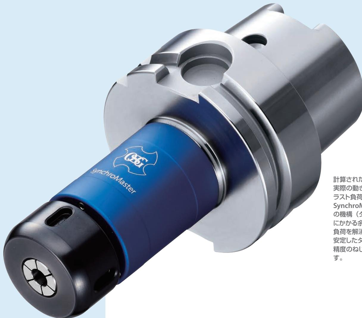
計算された送り量とタップの実際の動きの誤差により、スラスト負荷が増えます。SynchroMaster が持つ独自の機構（ダンパ）が、タップにかかる余分な軸方向の加工負荷を解消し、長い工具寿命、安定したタッピング性能、高精度のねじ品位を実現します。
