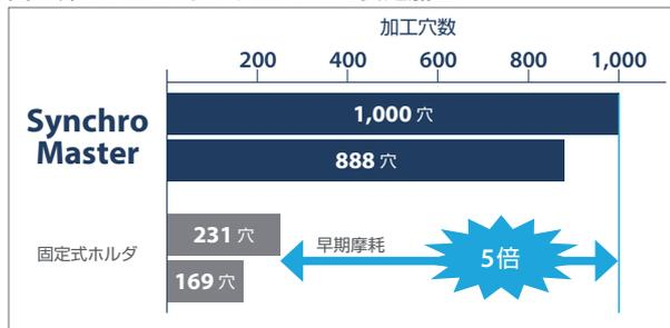
被削材：S45C 使用工具：A-SFT M4 x 0.7 1P 切削速度：10m/min
