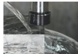
内部給油装置付き工作機械をお使いの場合 When using a machine tool equipped with an internal coolant supply system
