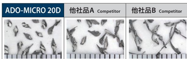
2 クーラント吐出量が多く、安定加工 Large coolant flow volume to enable stable drilling
