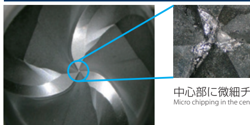
従来ボールエンドミル2刃 Conventional 2-flute ball end mill
