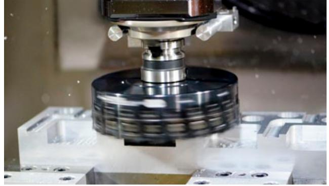
大径カッタを用いることでカッタバスの継ぎ目の無い加工面が得られた。BT30の小型マシニングセンタを使用しても、中仕上げ、仕上げ共に安定した加工が行え良好な加工面を得ることが出来た。
