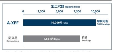
マルテンサイト系ステンレス鋼の小径ねじ加工でも抜群の耐久性
