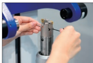
ISO50に基づくツールホルダスピンドル(BT50)
