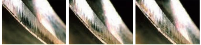
3刃とも安定した摩耗状態で継続切削可能
