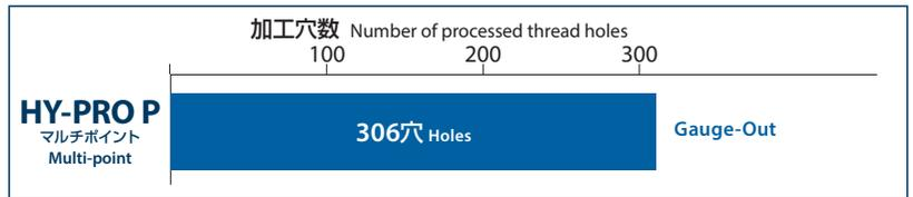
BT40の機械でM26×1.5のめねじ加工を実現しました。大径ねじの加工にも関わらず、片面で300穴、両面使用で600穴以上の加工が可能。これは通常の切削タップと比較して同等以上の経済性です。
