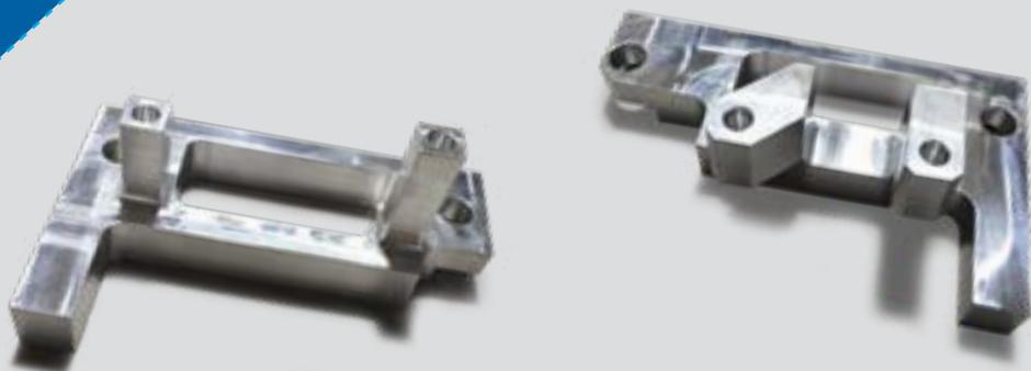
Micro Technology 社は、CAT 40 テーパー工具ホルダを備えた HAAS VF-3 という立形マシニングセンタを使用しています。機械加工されている部品は 6061 アルミ合金で、この会社のニーズを満たす上での許容差の条件は  $\pm 0.002$ ”です。Wright Jr. は、回転数 3,000rpm、120ipm で作動し、切削深さが軸方向 1.25”で半径方向 1.2”の競合他社の正面フライスを使用して部品を加工していました。彼は、品質も精度も犠牲にすることなく生産性を高めようとしたのです。用途を入念に評価することで、Woody は、直径 12mm のアルミニウム用インサート (EDP# 7811013) を使うオーエスジの Phoenix PRC インデキサブルラジアスカッタ (EDP #7800404) を推奨しました。
