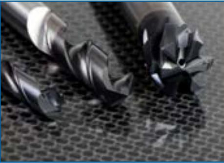
産業ロボットとプログラムの設計に加えて、金属切削ロボットに使用する切削工具も進化を続けなければなりません。直列接続ロボットは、高精度な切削に必要な剛性が不足しがちなため、切削工具を鋭利にして切削抵抗を最小化しなければなりません。高精度金属切削ロボットでは、切削工具が重要な役割を果たします。切削抵抗を小さくするには、刃先を鋭利にすることが必要です。ただし、鋭利にし過ぎると刃先が欠けやすくなります。オーエスジーの技術チームは、金属切削ロボットに最適な鋭利さと耐久性のバランスを実現する、新しい工具形状の研究と試験を続けています。難削材の加工では、工具形状に加えて、切削工具のコーティングも決定要因となります。ナノコーティングなどのコー
