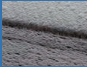
他社ダイヤモンドコーティング Competitor's Diamond Coating
