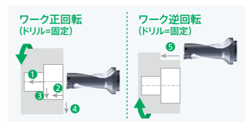
①むくからの穴あけ ②内径旋削 ③端面旋削 ④端面旋削 ⑤外径旋削
