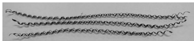
図3.4.2 スパイラルタップ切りくず
