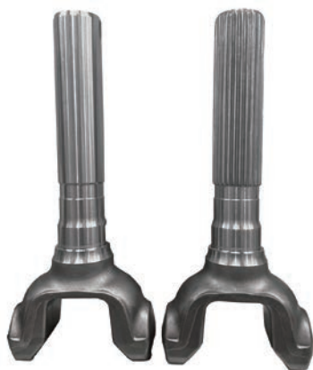
左からラックダイスによる加工前後の鋼製スプラインヨークシャフト。機械加工後、シャフトにスプラインを転造加工します。
