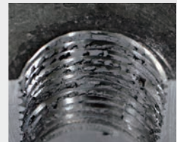
図2 むしれが発生した状態
