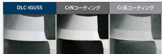
図 4 420m 加工後のボール部逃げ面摩耗状態
