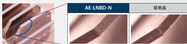
図 5 バリのない良好なエッジ
