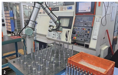
2. Mazak Nexus 150-II CNC 旋盤でソリュブルタイプの水溶性切削油剤（濃度 10%）を用いて加工され、部品 1 個あたり深さ 55mm（止り穴）のドリルによる下穴加工とリーマによる仕上げ加工を行っています。
