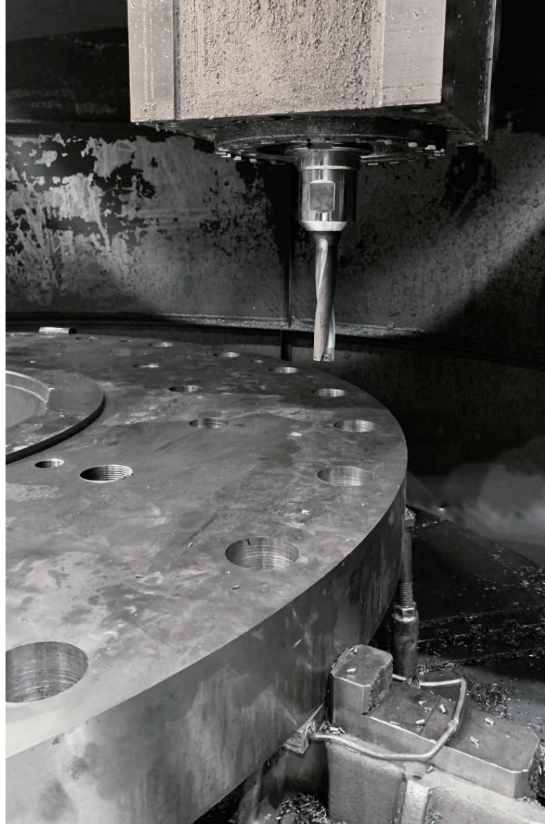
オーエスジーのインデキサブルドリル OSG Phoenix P5D は、鋳鉄およびダクタイル鋳鉄で作られているスラリーポンプの製作における穴加工に用いられます。
