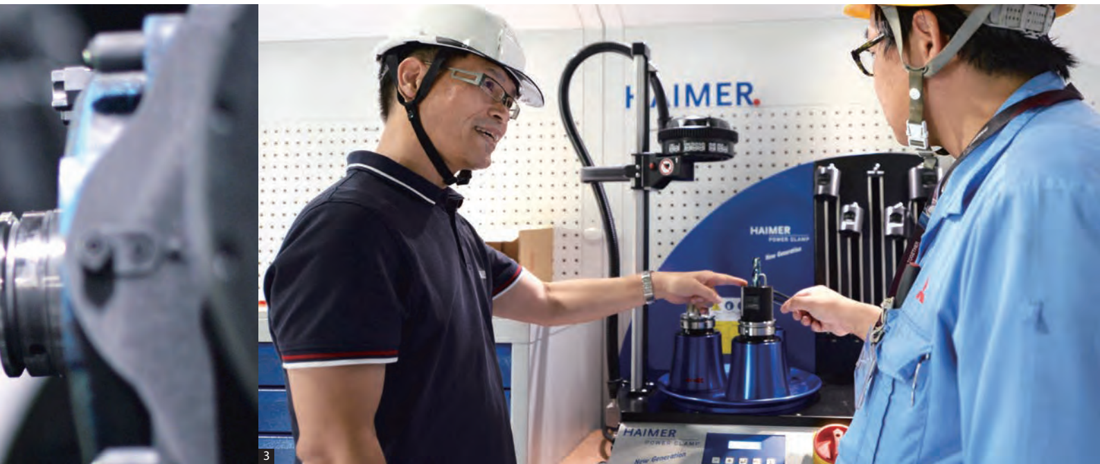
3. 中野氏（右）とハイマージャパン営業の山下氏（左） ハイマー製焼きばめ装置は加熱時間が短いため、段取り作業の時間短縮にも役立っている。
