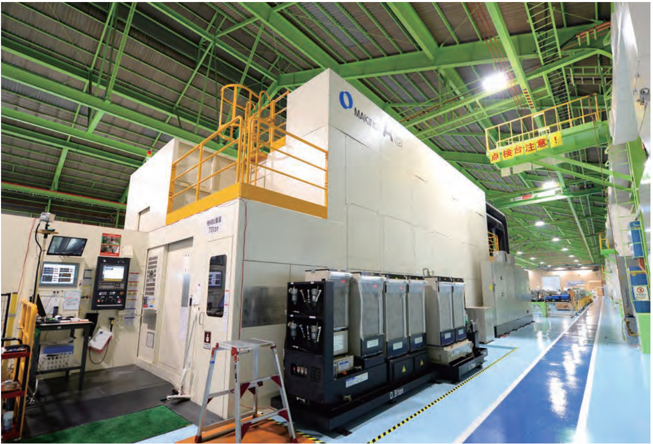
牧野フライス製作所製 A6 最高回転数 33,000min -1 、最高出力 120kW を誇る航空機アルミ構造部品用の 5 軸制御高速高出力横形マシニングセンター
