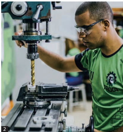
2. ロボットの構造部品の加工にオーエスジーのドリルを使用する TROIA の Thales Roger さん。
