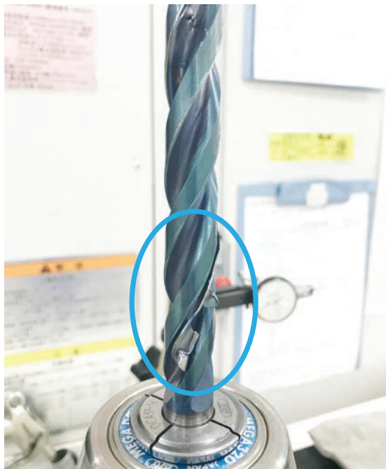
図 3 SCM440 加工後の従来の 3 枚刃ドリルの状態
