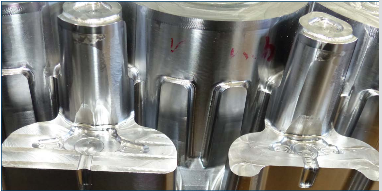
深く狭い部位があるウォータージャケットを加工する際、オーエスジエのエンドミルを使用すれば、3軸マシニングセンタであっても5軸マシニングセンタよりも高い能率を発揮することができることが実証されています。
