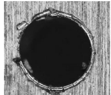
穴の入口に発生するばりの例
