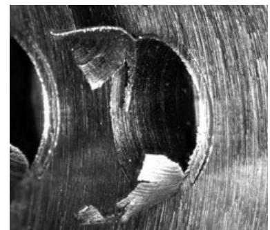
穴の出口に発生するばりの例
