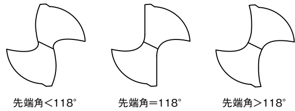
図1.3.15 先端角 118^\circ のドリル
